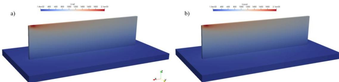
Figure 6 : Comparaison du champ thermique obtenue a) par MEF d'ordre plein et b) par calcul hybride MEF-POD après le dépôt de la 25<sup>ième</sup> couche
