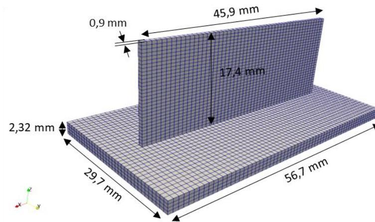
Figure 4 : Dimensions et maillage du mur de 30 couches
