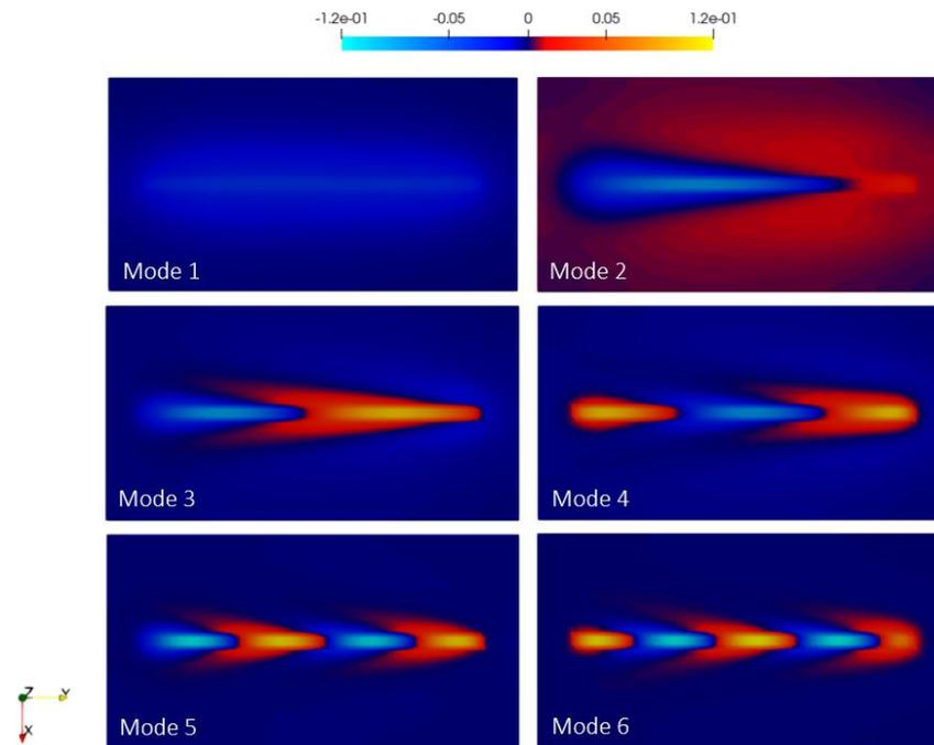
Figure 5 : Représentation des 6 premiers modes thermiques extraits du substrat
