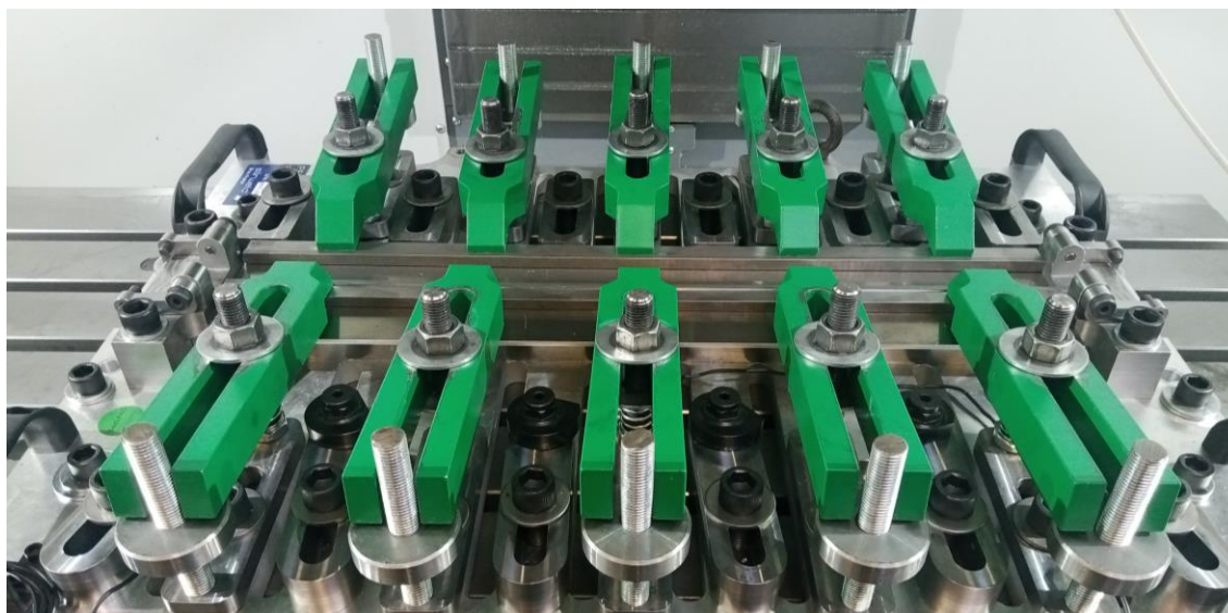
Figure 5 – Système de bridage des essais FSW
