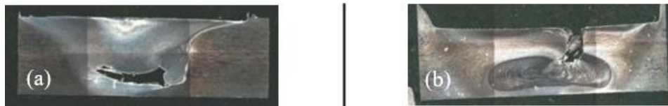
Figure 3 - Défauts de porosités : soudure froide (a) soudure chaude (b)
