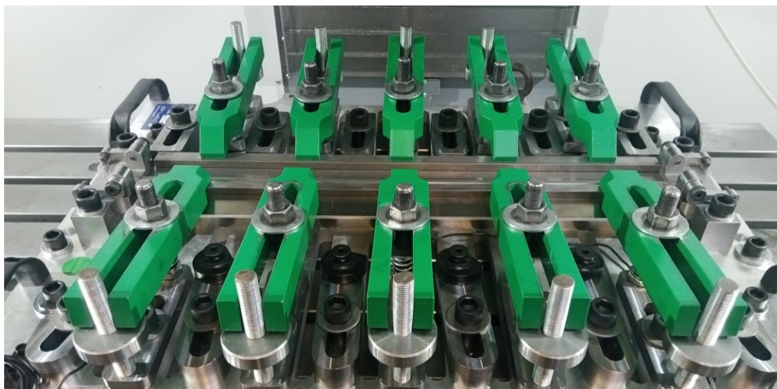
Figure 5 – Système de bridage des essais FSW
