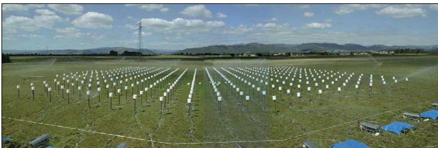
Figure 5. Banc d'asperseurs, station expérimentale du Merle, Lermi, Cemagref Aix en Provence.
