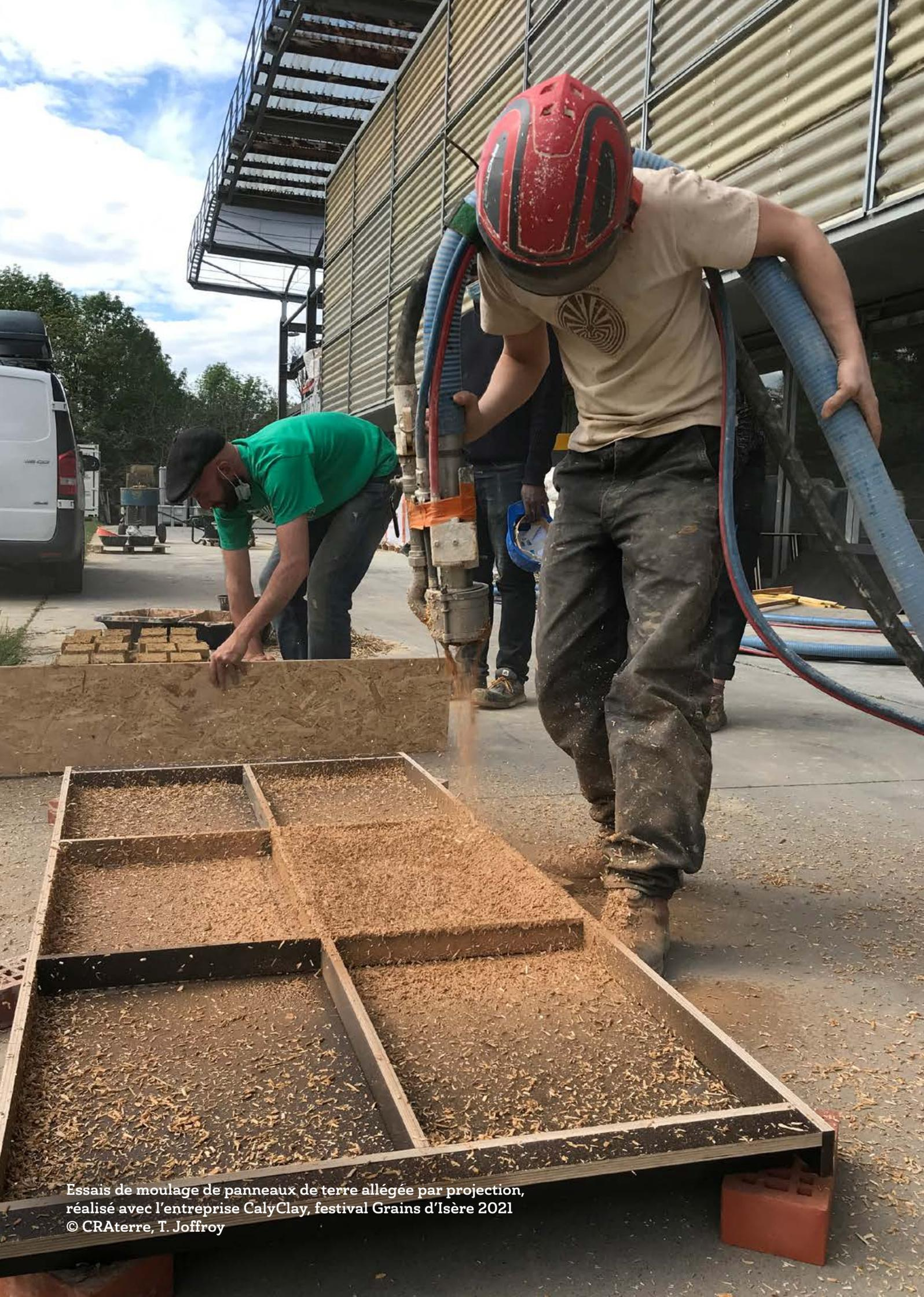
Essais de moulage de panneaux de terre allégée par projection, réalisé avec l'entreprise CalyClay, festival Grains d'Isère 2021
