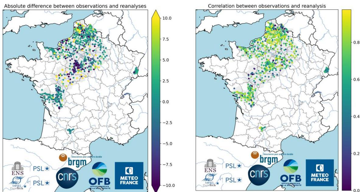
Figure 10. Comparaison entre la ré-analyse Aquif-FR sur la période 1958-2020 et les 700 points d'observation de piézométrie sur l'ensemble de la durée commune entre observations et simulations : à gauche : en termes de biais moyens (score parfait = 0), à droite, en termes de corrélation (score parfait = 1). Figure issue de (Mounier, 2021).
