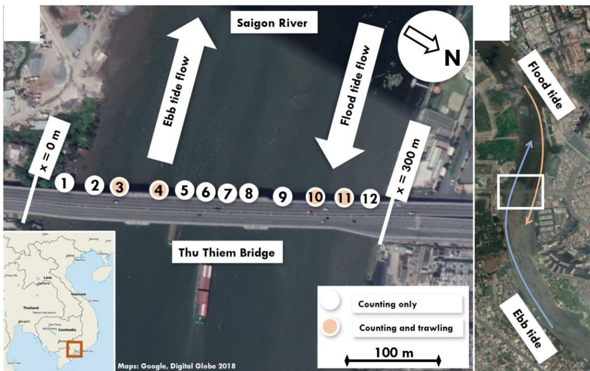
711 Figure 13 : Exemple de comptages visuels depuis le pont Thu Thiem sur la rivière Saïgon au Vietnam dans un 712 contexte de courant bidirectionnel lié aux marées. Les nombres correspondent à l'emplacement des observateurs. 713 Parmi les 12 observateurs, 4 sont également équipés d'un filet de collecte pour capturer des flottants afin de les 714 analyser plus finement (distribution de taille, de masse, etc.). Source van Emmerik et al. (2018).
