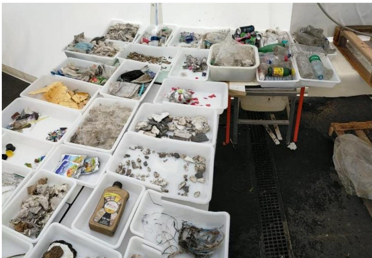
*Photo 3 : Macrodéchets triés disposés dans des bacs avant d'être comptés et pesés par catégorie*
