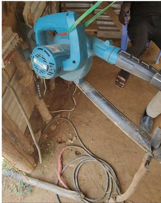
*Photo 9 : exemple d'un souffleur à poussière détourné pour alimenter en air frais un puit. Les gâchettes sont forcées pour maintenir une ventilation continue. L'ensemble est relié à des conduites qui descendent à plusieurs dizaines de mètres.*
