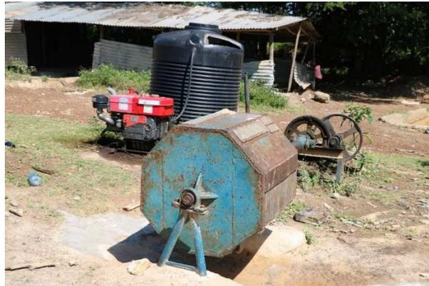
*Photo 6 : Tambour de broyage au premier plan, derrière son moteur fabriqué en Chine, entre les deux, sur la droite, les éléments de transmission mécanique. J. Bohbot, juin, 2022*
