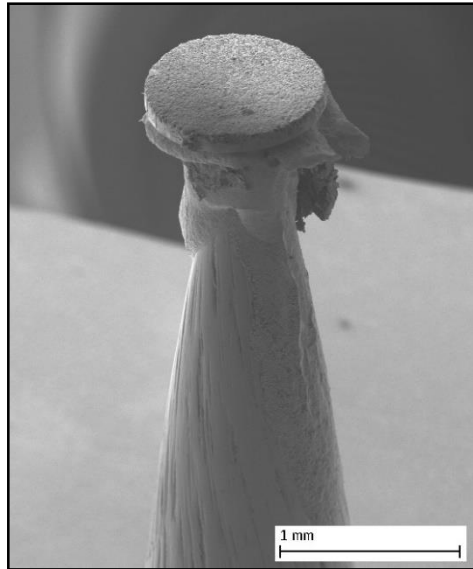
Disque collé sur la pointe (laque à l'argent)
