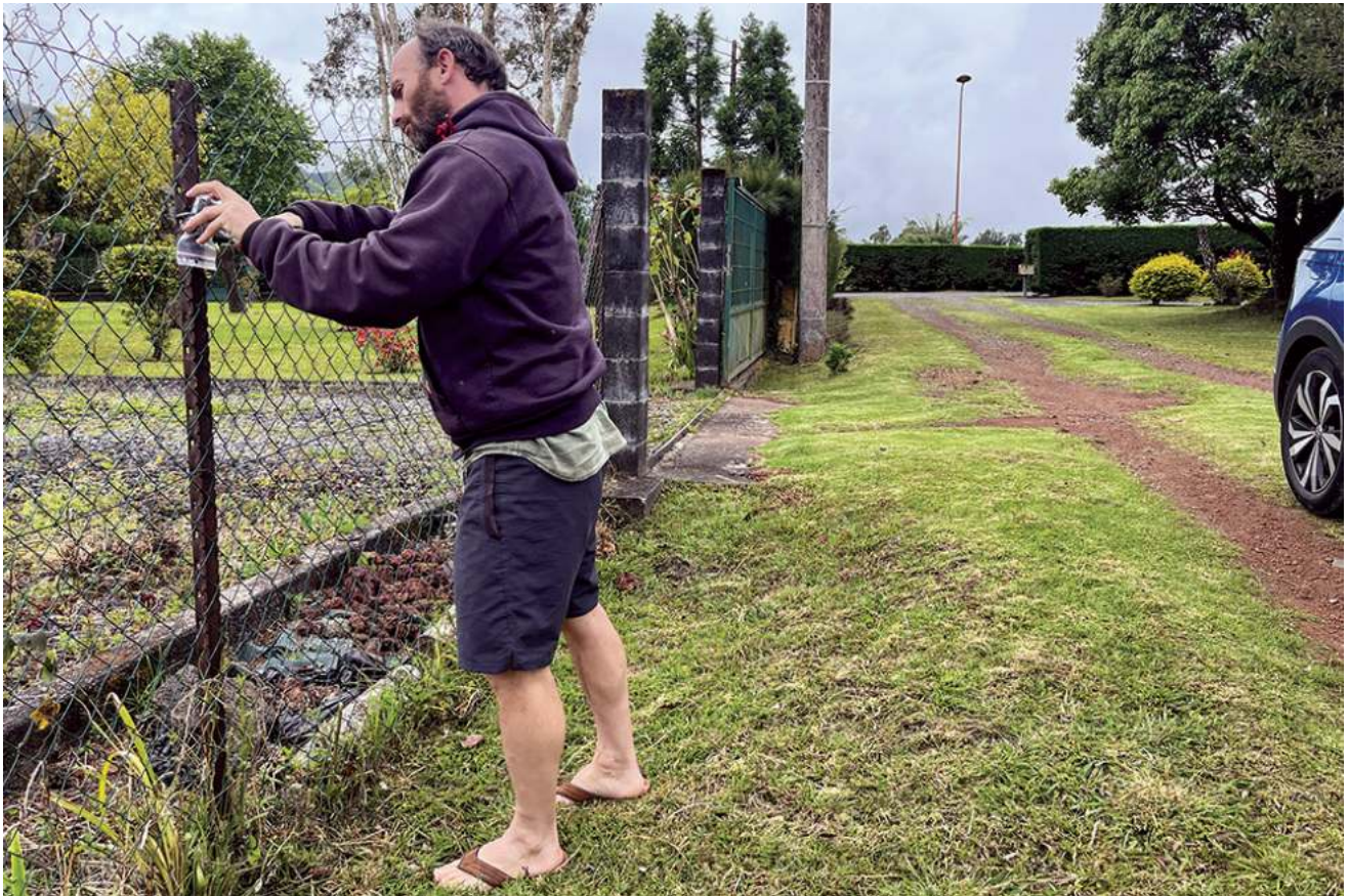
Le deuxième temps de l'atelier. Dépose par l'équipe recherche des enregistreurs acoustiques programmables installés la veille par les habitants participant à l'atelier, avant extraction des données puis traitement par intelligence artificielle complété par le croisement des expertises entre écologistes et géographes © Rémi Bénos / GÉODE / Observatoire de l'environnement nocturne
