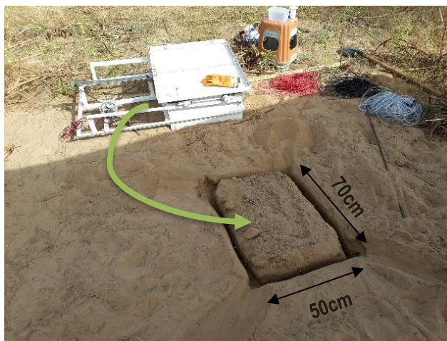
Figure 6. Installation d'une chambre de mesure sur site
