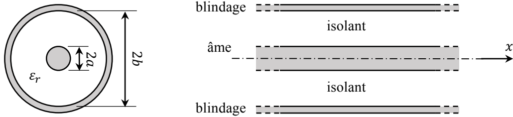
Figure 6 - Schémas d'un câble coaxial, en coupe droite (à gauche) et en coupe axiale (à droite).
