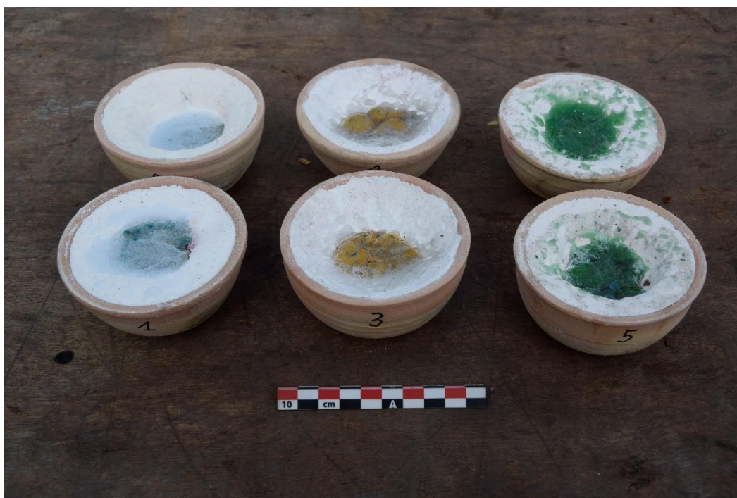
Fig. 2. Les 6 essais réalisés à l'aide des 3 types de verre.
