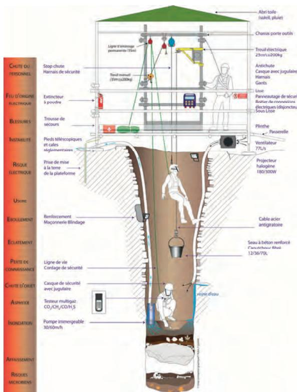
Figure 1 : schéma type d'intervention et de prévention des risques.
