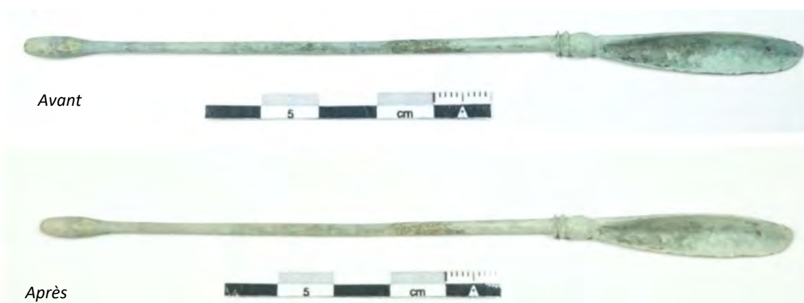
Figure 5. Instrument de toilette en alliage cuivreux photographié avant et après le traitement biopatine.
