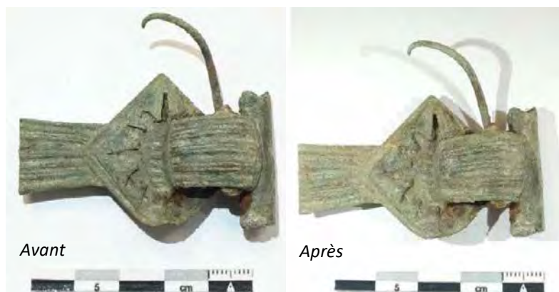
Figure 8. Photographies avant et après le traitement biopatine réalisé en masse pendant 14 jours.
