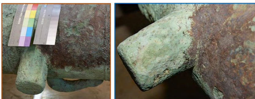
Figure 13. Zoom sur une partie du canon, avant et après application du gel chargée de souches fongiques.
