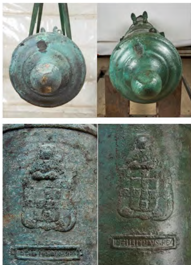
Figure 9. Canon en alliage cuivreux découvert au large de Bidart en 1979 – photos avant restauration (à gauche) et après restauration, avec l'application de la patine chimique (à droite).
