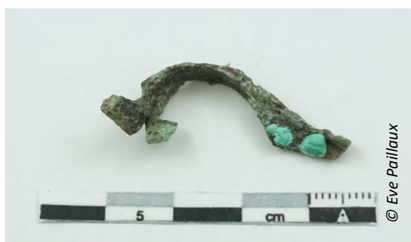
Figure 6. Réactivation de la corrosion en chambre humide à 97 % d'HR après un traitement biopatine de 7 jours.
