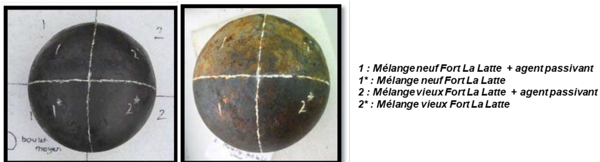
Figure 5. Boulet protégé par le mélange « Fort La Latte » avant (à gauche) et après 7 mois d'exposition (à droite).
