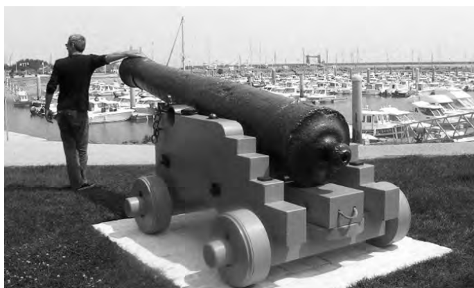
Figure 1. Canon traité par Arc'Antique en 1998, protégé par des couches de résines polyuréthane et époxyde, exposé à proximité de l'océan Atlantique sur l'île d'Oléron.
