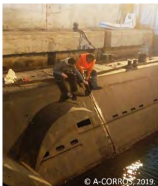
Figure 10. Vérification des connecteurs d'anodes, © A-CORROS 2019.
