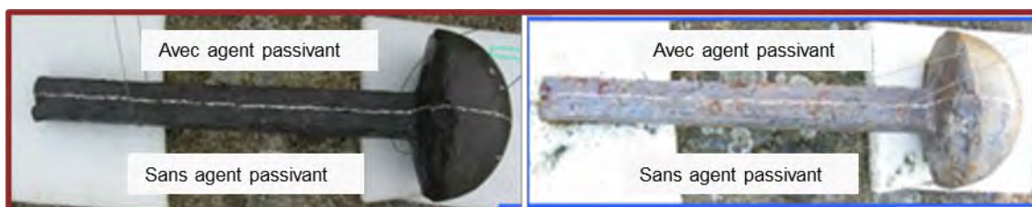
Figure 6. Boulet ramé protégé par la cire microcristalline avec et sans agent passivant, avant (à gauche) et après 7 mois d'exposition (à droite).
