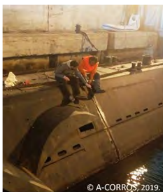
Figure 10. Vérification des connecteurs d'anodes, © A-CORROS 2019.
