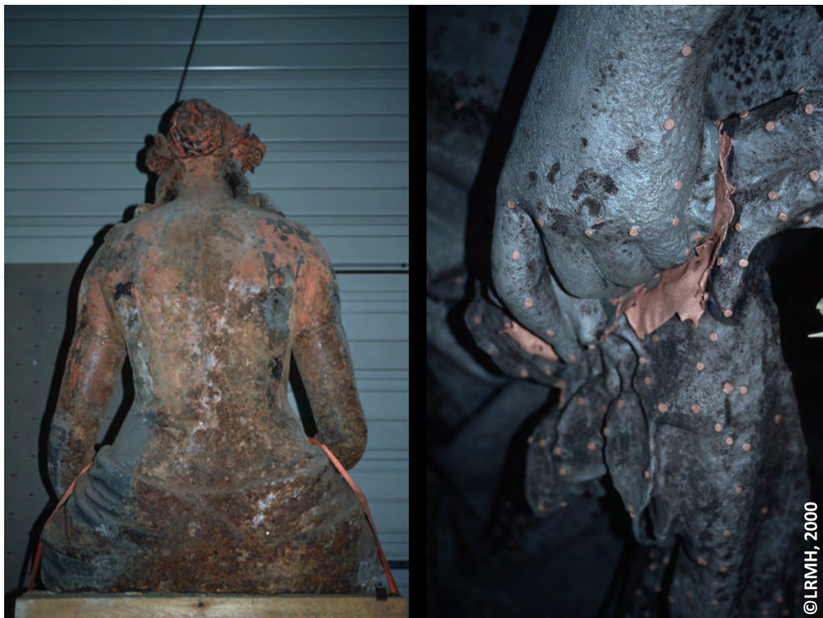
Figure 2. Cuivrage de fontaine des mers de la place de la Concorde ; à gauche, sculpture avant restauration ; à droite, élément de sculpture décapé faisant apparaître les rivets en cuivre et les zones noires de graphitisation de la fonte de fer ©LRMH 2000.
