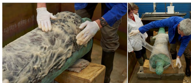
Figure 11. Application du gel chargée de souches fongiques et mise en place du film microperforé sur le canon en bronze.
