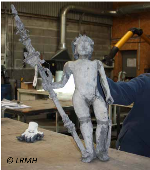
Figure 9. La corrosion a fait apparaître en gris foncé les assemblages (à gauche) et les réparations (à droite) effectués par brasure. © LRMH
