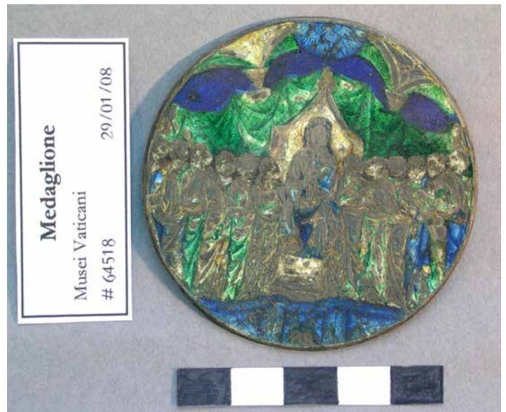
Figure 3. Émail de basse-taille sur argent présentant un soulèvement et une perte des émaux transparents colorés (médaillon, Musei Vaticani) ©Agnès Gall-Ortik
