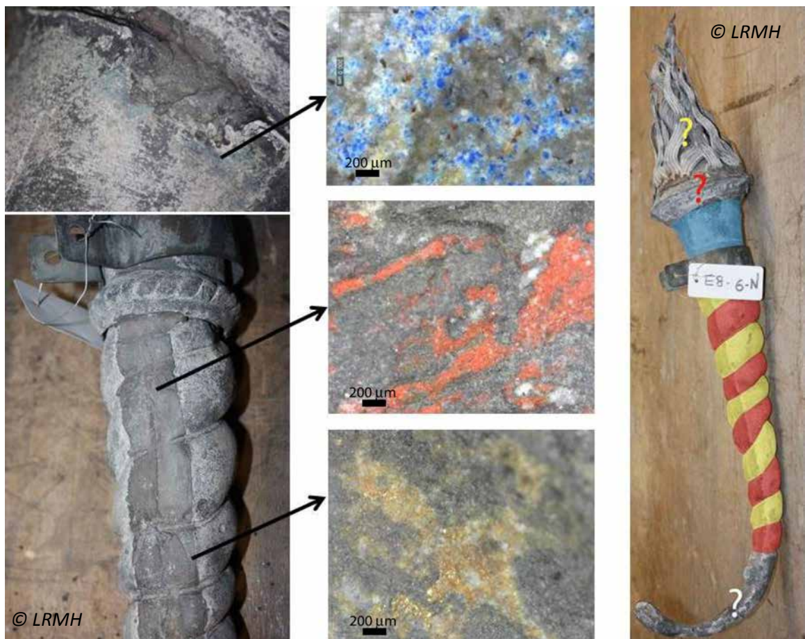
Figure 10. Traces de peintures observées sur l'épi E8 (pièce 6N) du château d'Azay-le-Rideau. Le pigment rouge est du cinabre ( HgS ), le pigment bleu correspond à l'azurite ( Cu_3(CO_3)_2(OH)_2 ) et la couche jaune révèle des restes de paillettes d'or. Une proposition de restitution de la répartition des couleurs est proposée sur l'image de droite.
