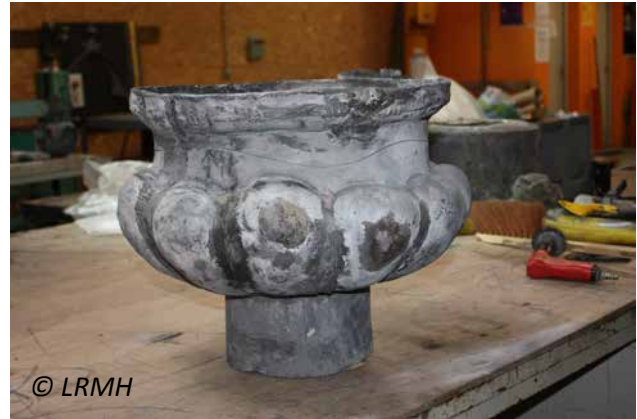
Figure 9. La corrosion a fait apparaître en gris foncé les assemblages (à gauche) et les réparations (à droite) effectués par brasure. © LRMH
