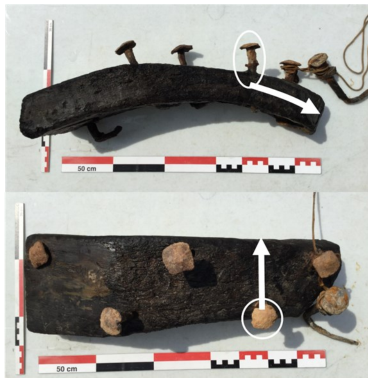
Figure 1. Élément de membrure avec clous, extrait de l'épave Ep2 Courbiac, Saintes-Foncouverte. Les flèches désignent le sens transversal et longitudinal de découpe des échantillons à partir du clou entouré
