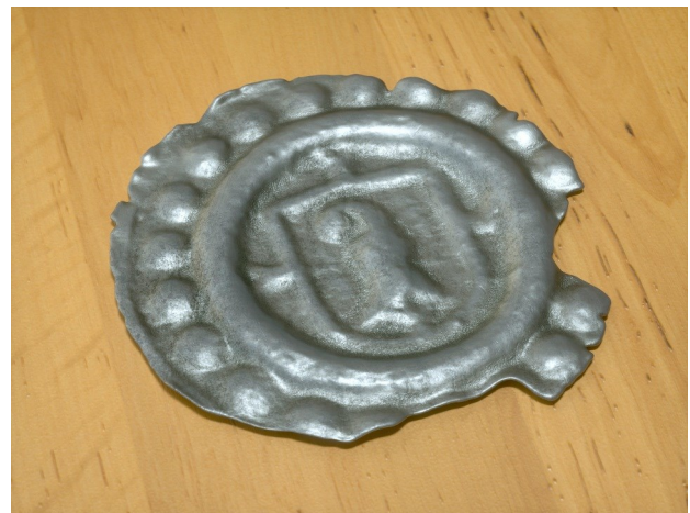
Figure 6 : Images du CT en voxel transformées en topographie de surface, qui permettront l'impression en 3D par la suite
