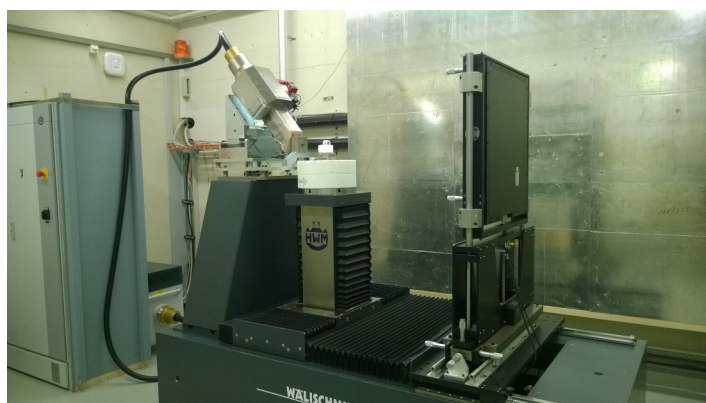
Figure 2 : L'examen des monnaies par tomographie aux rayons x à l'EMPA Dübendorf
