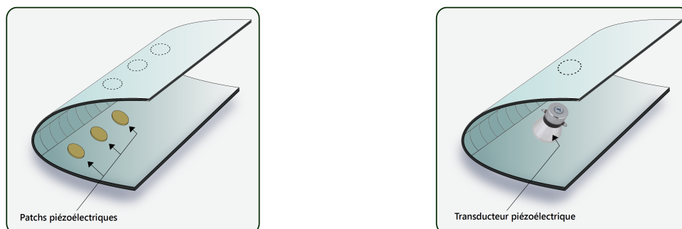
Figure 1 : Configuration d'un système de dégivrage piézoélectrique avec des patches nus et des transducteurs.
