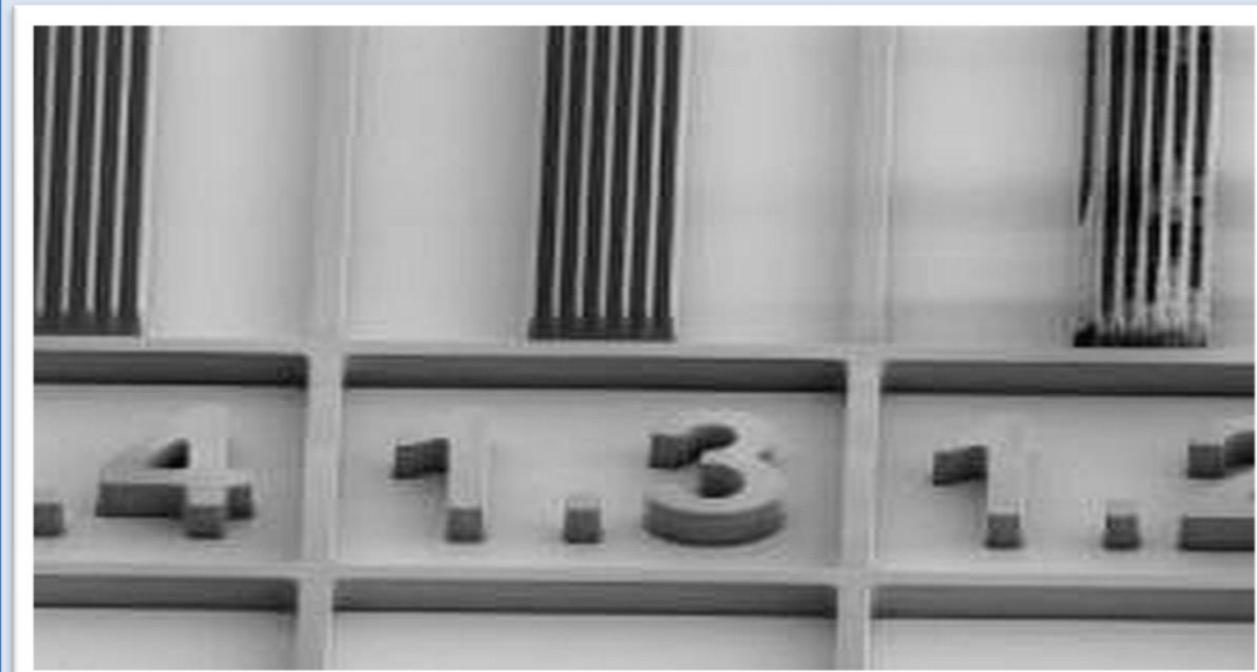
Qualification des procédés génériques, résine ECI 3012 épaisseur 1µm
