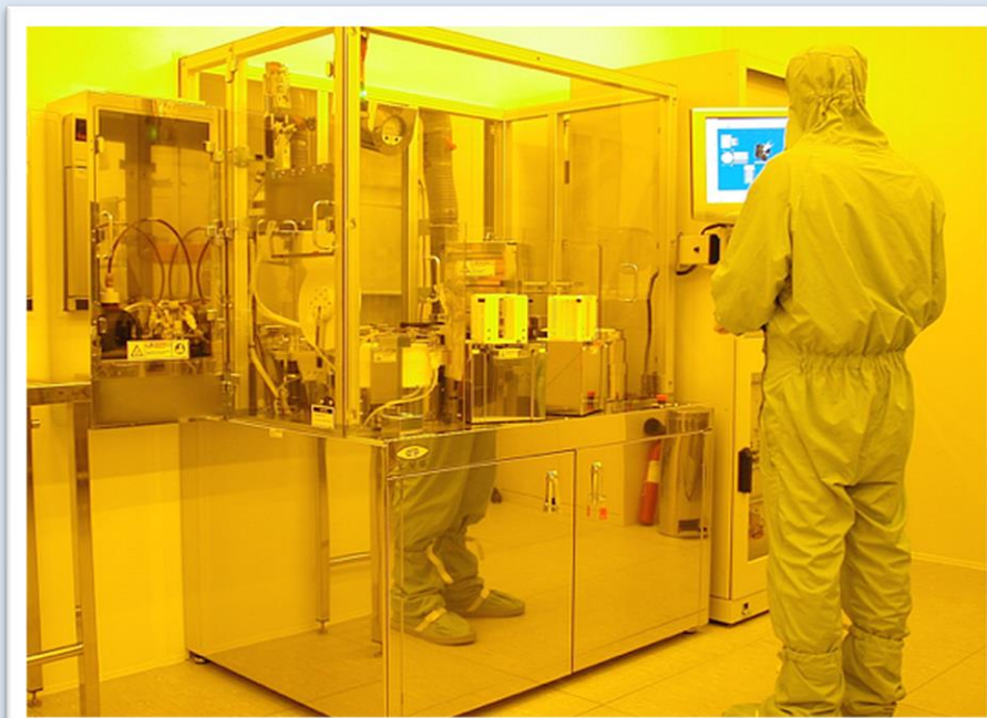
EVG 120, dépôts, recuits et développements automatiques
