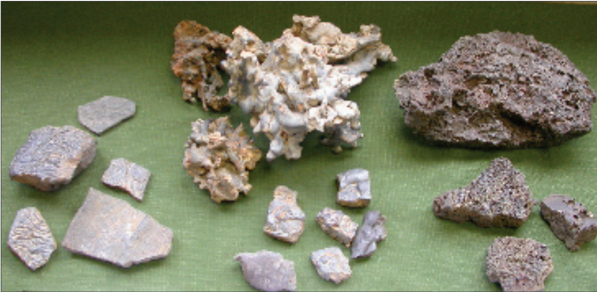
Fig. 11. Typologie des scories. À gauche , scories coulées en plaquette ; au milieu , scories piégées à coulures internes (au fond) et scories coulées en cordons (devant) ; à droite , scories coulées spongieuses (fin du Moyen Âge).
