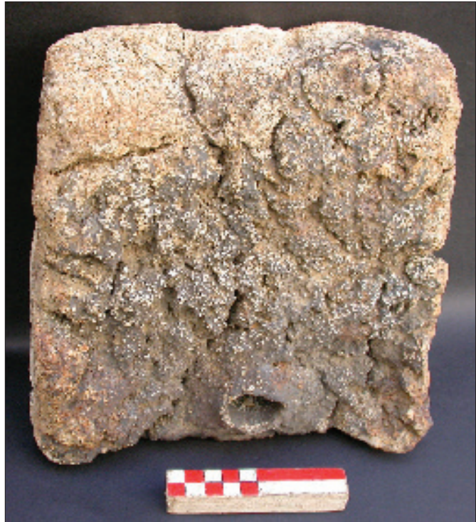
Fig. 13. Le Rocher Abraham en Saint-Pierre-de-Plesguen : bloc-tuyère n°1, scoriacé et crevassé par la chauffe.
