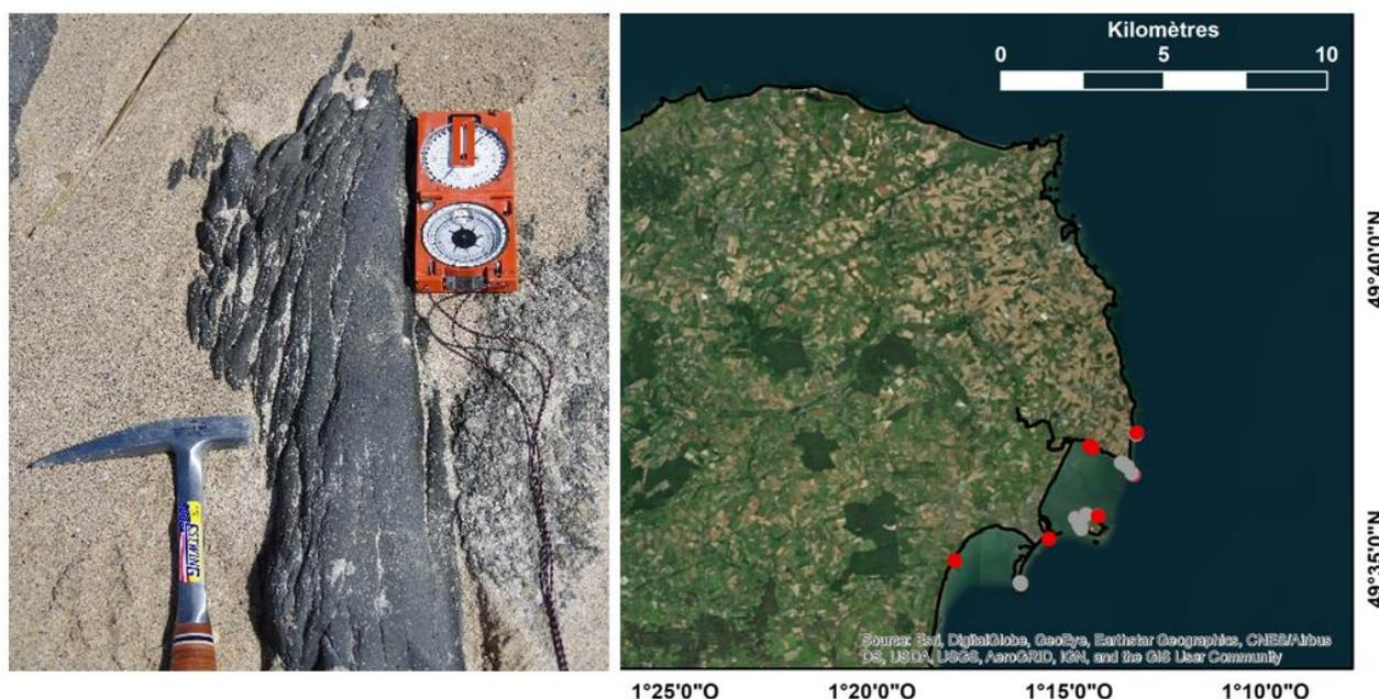
Figure 10 : A gauche, photographie de relevé de schistosité/fracturation à la boussole (cliché A. Duperret). A droite, localisation des stations de mesures (ensemble des points gris et rouges) et d'échantillonnage (points rouges).
