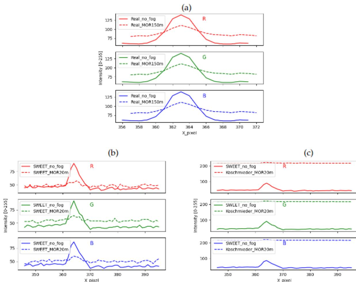
Figure 6 - Comparaison de l'intensité d'un segment de pixels, avec et sans brouillard, pour des images provenant d'une caméra réelle (a), du simulateur SWEET (b) et de Koschmieder (c).
