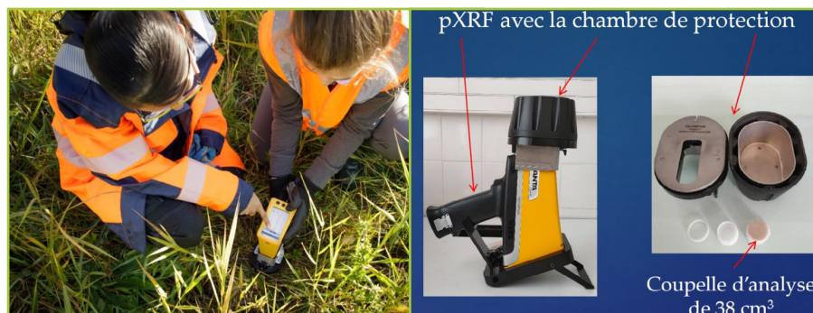
Figure 3 : Utilisation de l'analyseur pXRF in-situ (à gauche, lors d'une campagne de terrain) et ex-situ (à droite lors de la calibration de l'appareil)
