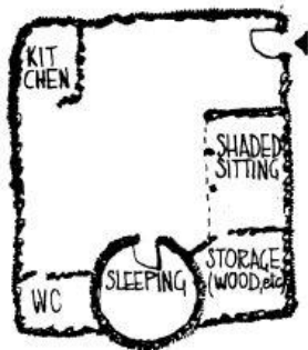
تخطيط منزل مستدير من القصب في ساحة ذات جدران عالية © فرناندو فاراندا
