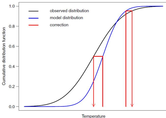
**FIGURE 5.2** – Schéma des corrections de biais par quantile-quantile. La valeur simulée, qui est un quantile de la distribution de la simulation (bleue), est remplacée par la valeur équivalente au même quantile dans la distribution observée (noire). Source : figure 2 de Maraun (2016).
