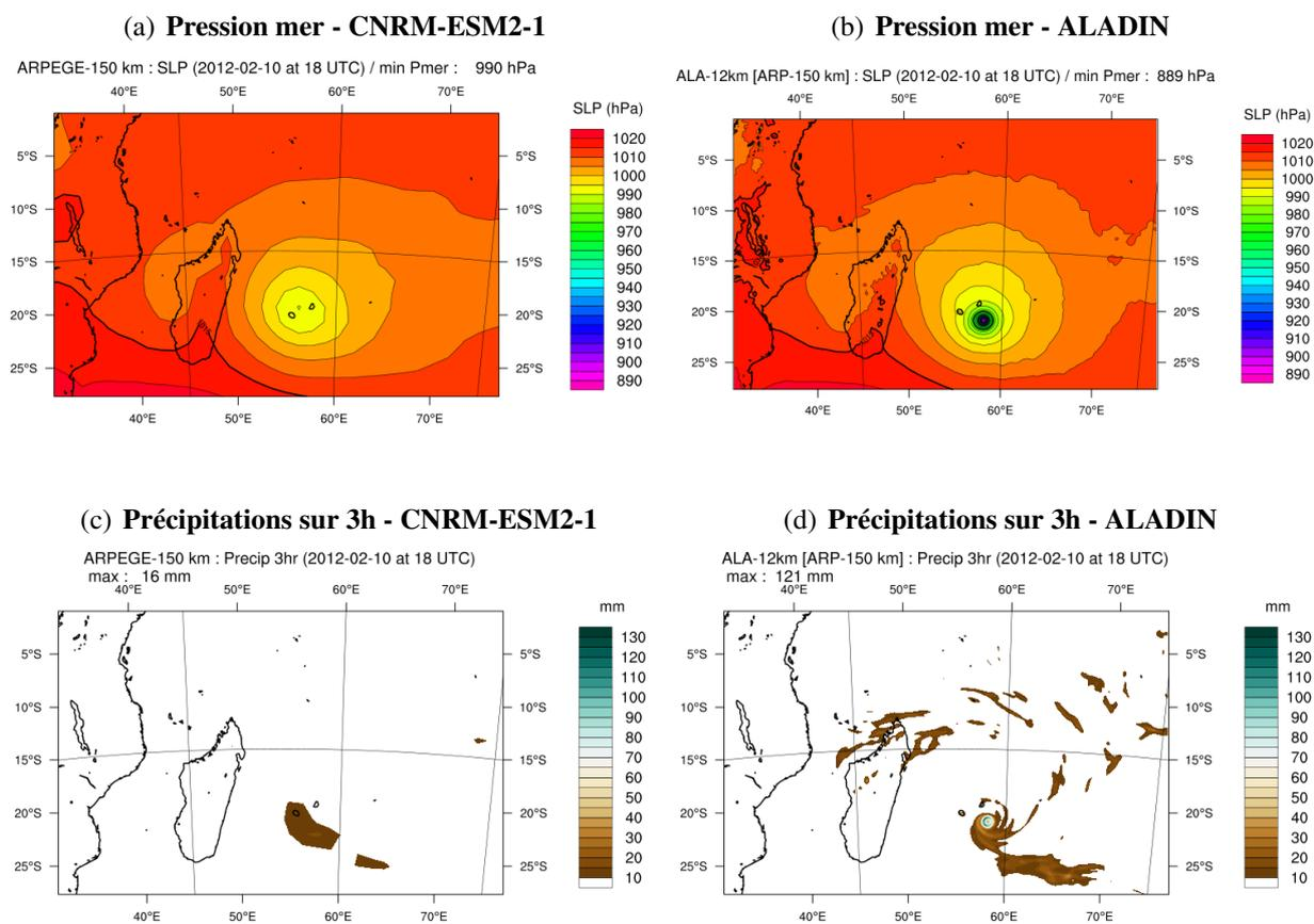
**FIGURE 3.2** – Pression au niveau de la mer en hPa (en haut) et précipitations cumulées sur 3 heures en mm (en bas) pour un exemple de système dépressionnaire simulé par le modèle global *CNRM-ESM2-1* (à gauche) et par le modèle régional *ALADIN* (à droite) le 10 février 2012 à 1800 UTC.
