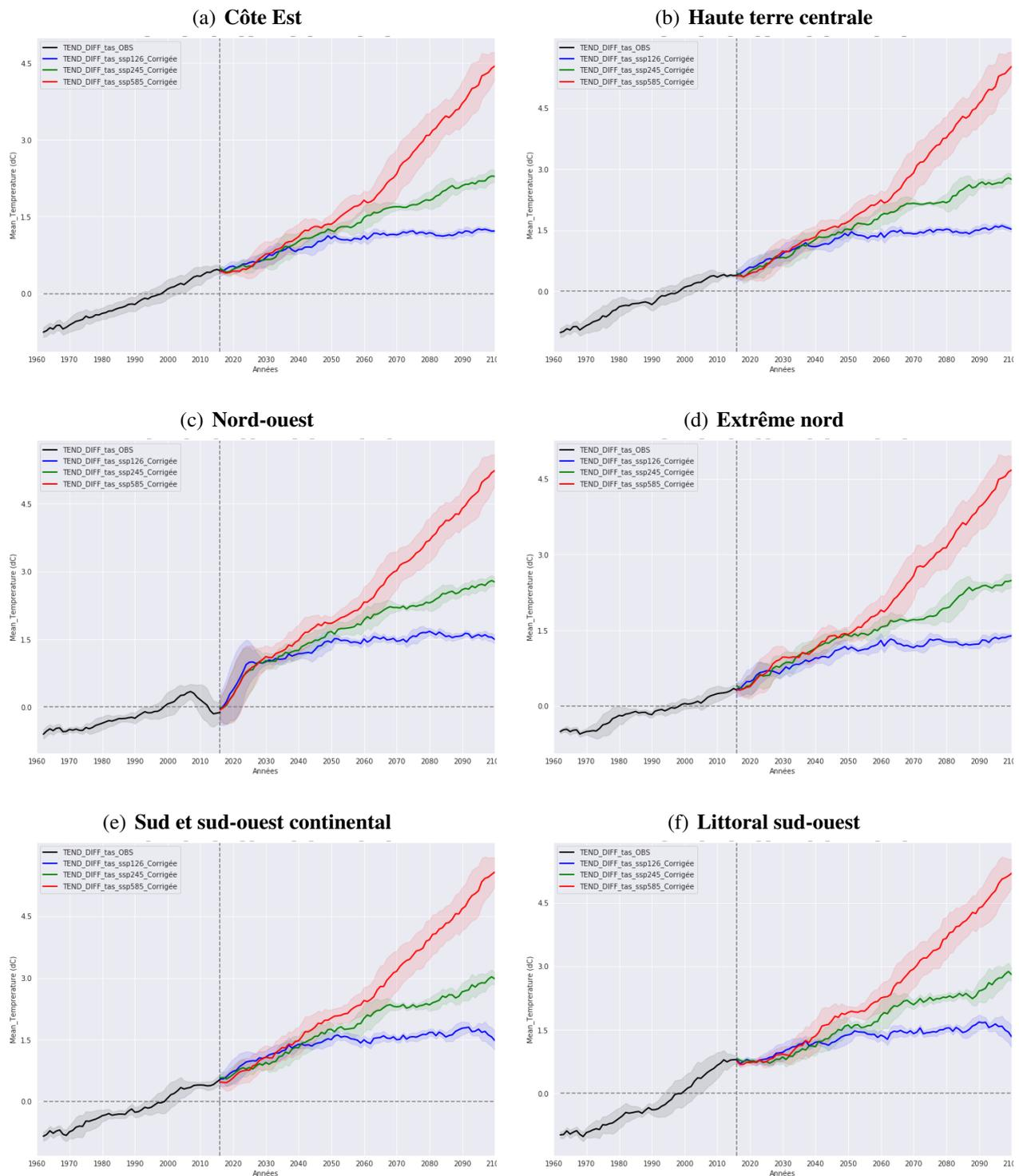
**FIGURE 6.40** – Evolution temporelle sur la période 1981-2100 des anomalies de température moyenne annuelle à +2 m ( $^{\circ}\text{C}$ ) sur les 6 zones climatiques de Madagascar selon le modèle régional ALADIN pour 3 scénarios SSP, après correction des biais. Les données d'observation sont en noir, l'historique modèle en gris, et les simulations du modèle pour 3 scénarios en couleurs. La ligne horizontale tiretée situe la moyenne de référence 1981-2010.
