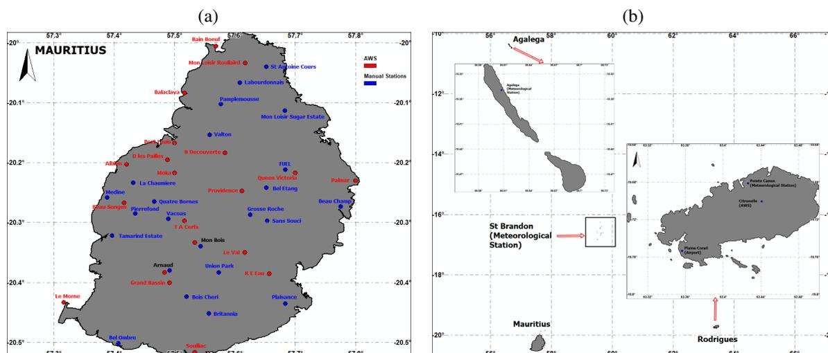
**FIGURE 4.15** – Stations de mesures automatiques (en rouge) et manuelles (en bleu) climatologiquement exploitables sur (a) Maurice, et (b) Rodrigues, Saint Brandon et Agalega pour les précipitations et la température sur la période 1981-2010.
