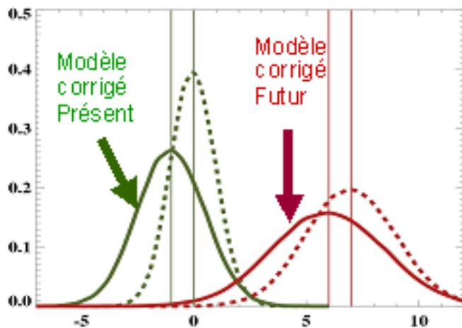
**FIGURE 5.3** – Illustration des distributions de probabilité (PDF) historique (en vert) et future (en rouge) de la température minimale simulée par un modèle en France avant (pointillés) et après (traits continus) correction de ses biais sur une station en métropole. En abscisse figurent les valeurs en température et en ordonnée les probabilités ou quantiles. Source : [DRIAS http://www.drias-climat.fr/accompagnement/sections/63](http://www.drias-climat.fr/accompagnement/sections/63).
