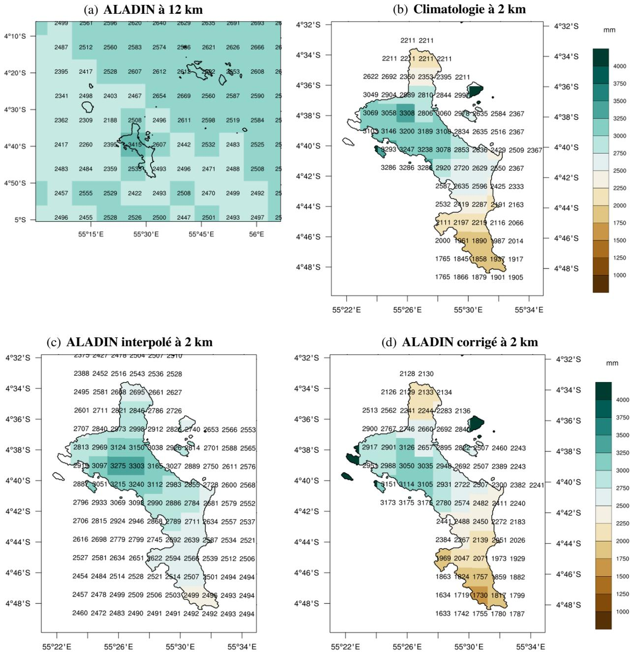
**FIGURE 5.22** – Cumul annuel moyen de précipitations (mm) sur l'île principale de Mahé, Seychelles, sur la période historique 1981-2010 dans (a) la sortie brute du modèle ALADIN à 12 km de résolution, (b) la climatologie de référence, (c) le modèle ALADIN après interpolation à la résolution de 2 km, et (d) le modèle ALADIN après correction des biais à la résolution de 2 km. Les nombres superposés sur les graphes indiquent les valeurs en chaque point de grille.
