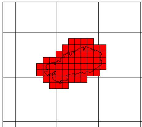
**FIGURE 4.16** – Grille des produits d'observation obtenus par interpolation sur Maurice, Saint Brandon, Agalega et Rodrigues pour les précipitations et la température sur la période 1981-2010. La grille d'ALADIN à 12 km de résolution est dessinée en comparaison.
