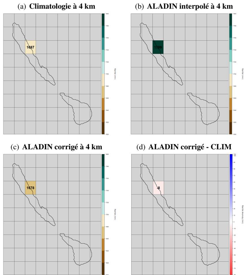
**FIGURE 5.13** – Cumul annuel moyen de précipitations (mm) sur Agalega sur la période historique 1981-2010 dans (a) la climatologie de référence, (b) le modèle *ALADIN* après interpolation à la résolution de 4 km, et (c) le modèle *ALADIN* après correction des biais à la résolution de 4 km; (d) illustre la différence entre (c) et (a), c'est-à-dire le biais résiduel après correction. Les nombres superposés sur les graphes indiquent les valeurs en chaque point de grille.
