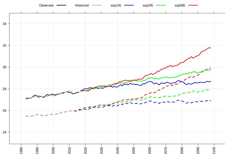
**FIGURE 5.23** – Evolution temporelle sur la période 1981-2100 de la température moyenne annuelle à +2 m (°C) simulée par le modèle ALADIN pour 3 scénarios SSP sur la station de référence de l'archipel des Seychelles (aéroport). Les données d'observation sont en noir, et les simulations d'ALADIN sont en gris pour l'historique et en couleurs pour les 3 scénarios. Les lignes continues (tiretées) indiquent les valeurs du modèle après (avant) corrections des biais.
