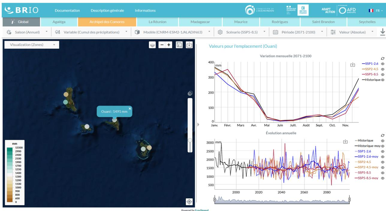
**FIGURE 7.2** – Illustration du portail régional du changement climatique. (Volet de gauche) vue en points de stations sur l'archipel des Comores; (volet de droite) visualisation pour 3 scénarios *SSP* et le couple de modèles *CNRM-ESM2-1/ALADIN63* sur la station choisie de Ouani : (en haut) cycle saisonnier sur la période 2071-2100 et (en bas) évolution annuelle des précipitations sur la période 1981-2010 avec superposition de la moyenne glissante sur 10 ans (courbes "-moy").
