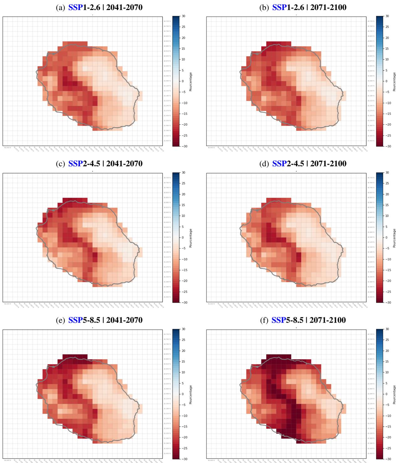
**FIGURE 7.6** – Anomalies du niveau de remplissage quotidien du réservoir utile *RU* (en % par rapport à la moyenne sur la période 1981-2010) sur La Réunion en milieu (gauche) et fin (droite) de siècle pour les scénarios *SSP1-2.6* (haut), *SSP2-4.5* (milieu), et *SSP5-8.5* (bas). Source : *Bérard (2021)*.
