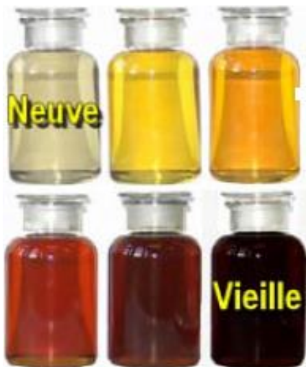
Fig 13 : Analyse des huiles de transformateur en fonction de leur couleur [6]
