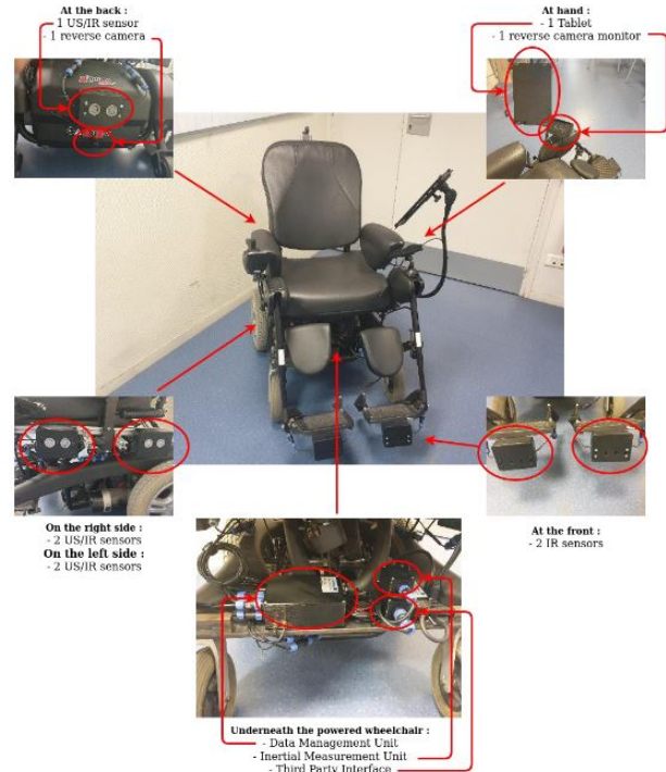
FIGURE 2. Partie matérielle du système d'alerte sur obstacle
