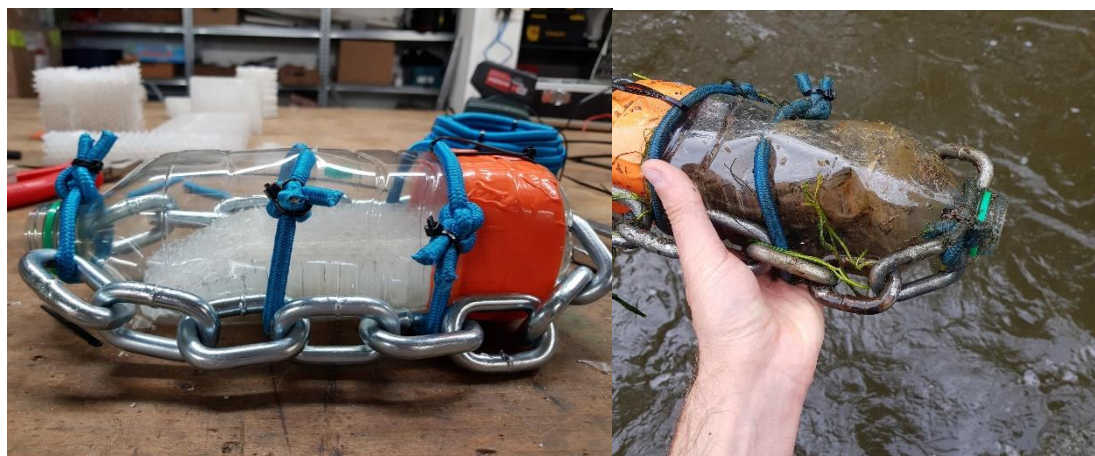
Figure 10 : Dispositif expérimental de piège à sédiment (avant la pose à gauche, après 14 jours à droite)
