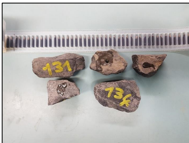
Figure 6 : Photographie de transpondeurs RFID placés dans des sédiments grossiers
