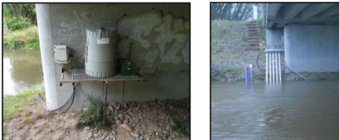
Figure 3 : Station de Virey, à l'amont (EDF-INRAE), à gauche : le préleveur installé par INRAE, À droite : les sondes et le dispositif de suivi installés par EDF
