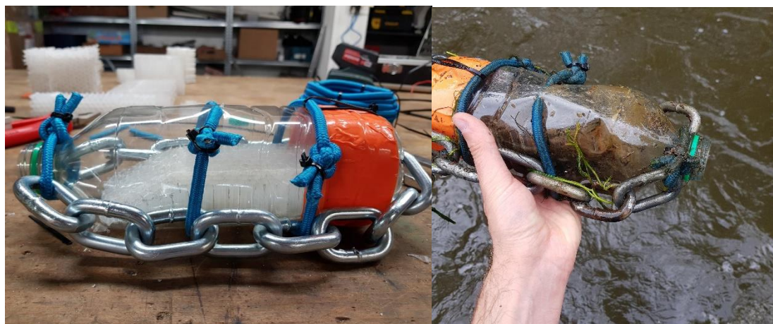
Figure 10 : Dispositif expérimental de piège à sédiment (avant la pose à gauche, après 14 jours à droite)
