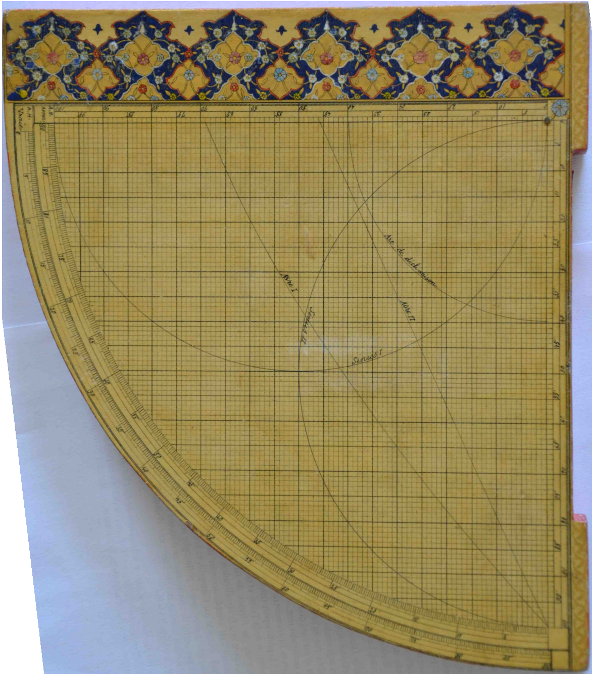
FIGURE 10 – Quadrant des sinus situé au dos de la partie astrolabe.
