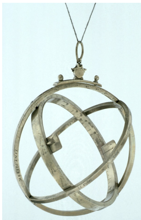
FIGURE 17 – Anneau astronomique signé Gualterus Arsenius daté de 1567 (Musée des sciences d'Oxford). Quinze étoiles sont gravées pour un usage nocturne de l'anneau afin de déterminer l'heure solaire de nuit.
