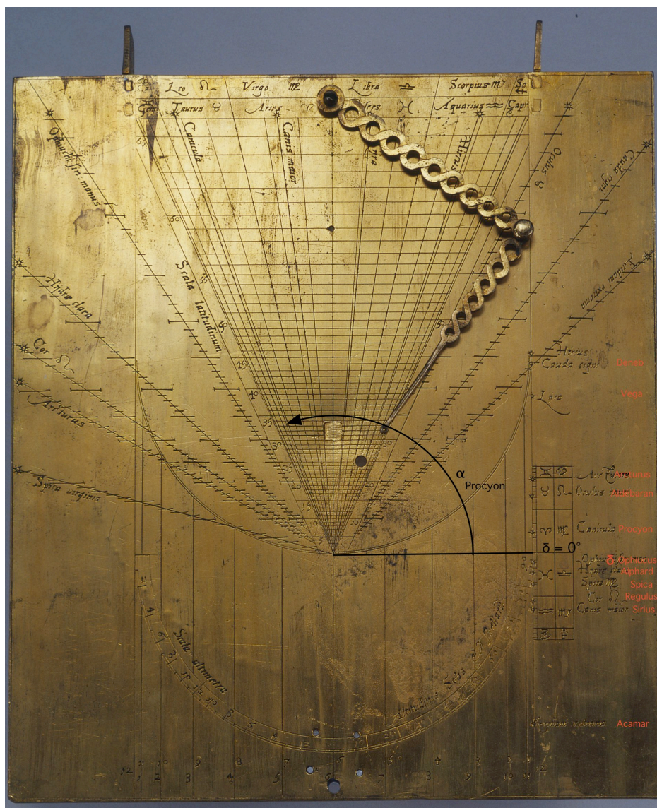
FIGURE 15 – Détail du cadran universel de Regiomontanus de Descrolières : de la pointe du trigone part un réseau de droites qui correspondent à l'ascension droite des étoiles.
