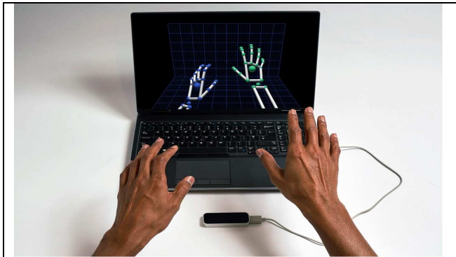
Fig. 1. Dispositif de capture des mains Leap Motion et rendu graphique des points d'intérêt (d'après ultraleap.com).
