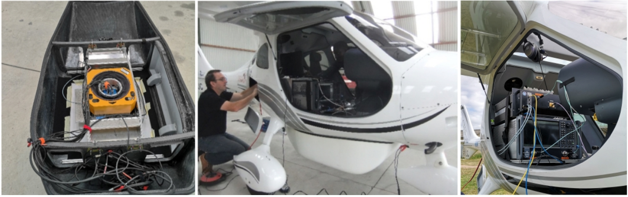
Figure 4. Étape de la mise en place du système global (a) cargopod, (b) intégration dans l'avion, (c) Partie RF dans la cabine.
