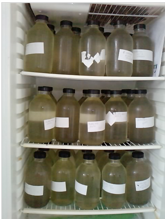
Stockage et conservation des échantillons d'eau en laboratoire à 6° C (campagne de juin-juillet 2010, situation T 1 )
