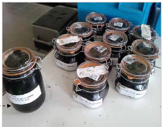
Echantillons frais de boue de curage en laboratoire
