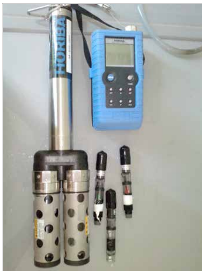
Sonde Multiparamètre U-23 Horiba
