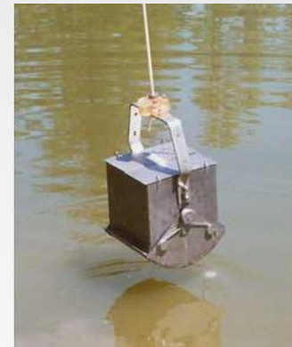
Echantillonnage à la benne Ekman
