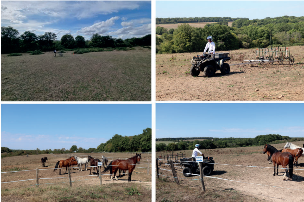
Figure n°70. Système d'acquisition magnétique à 5 sondes (MXPDA – Sensys) poussé par l'opérateur tracté par un quad. Vues du terrain en cours d'acquisition.
