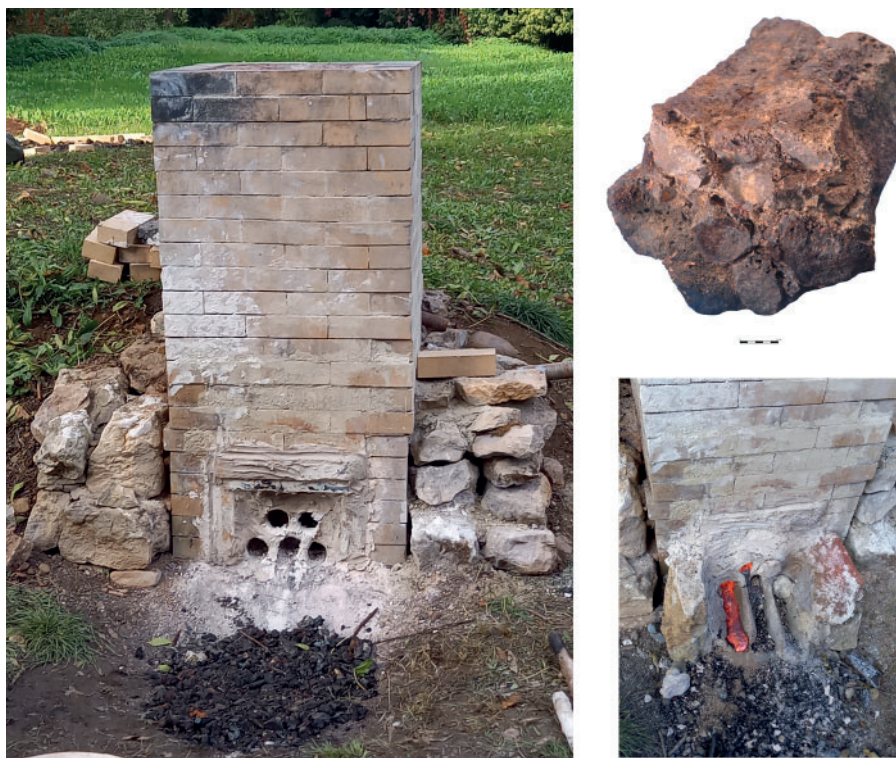
Figure n°6. Expérimentations de réduction du minerai de fer (fêtes de la Science 2022 - UTBM), afin de tenter de comprendre les conditions de formation des scories antique constituées de boudins de scories canalisés accolés (en haut à droite).
