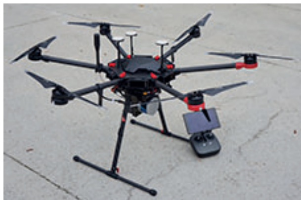
Figure n°50. Solution LiDAR aéroporté sur drone à la MSHE Ledoux.
