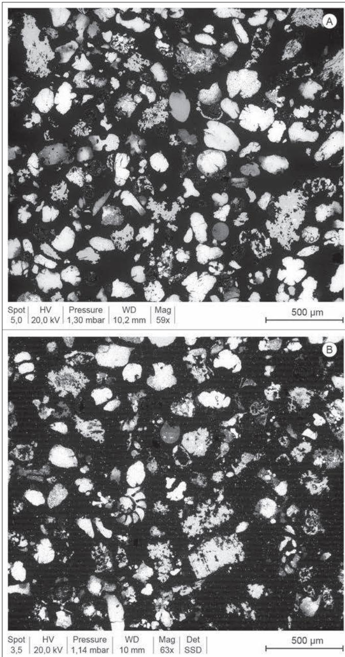
**Fig. 14** – Morphologie des grains résiduels de la pierre de Saintes (Charente-Maritime) révélée par la rétrodiffusion des électrons secondaires du MEB : **A**, Saintes-hôpital (SaH - plage 1); **B**, Saintes-amphithéâtre (SaR - plage 1) (clichés : E. Conforto, université de La Rochelle).
