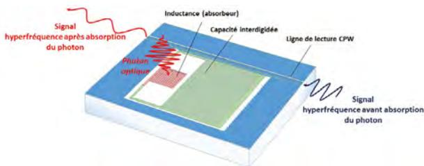
Dans cet article, nous présentons les MKIDs, pour « Microwave Kinetic Inductance Detectors », une nouvelle technologie de détecteur supraconducteur ultrasensible capable de détecter le photon et permettant de couvrir un large spectre électromagnétique allant des ondes millimétriques-submillimétriques aux rayons gamma, en passant par l'optique.
