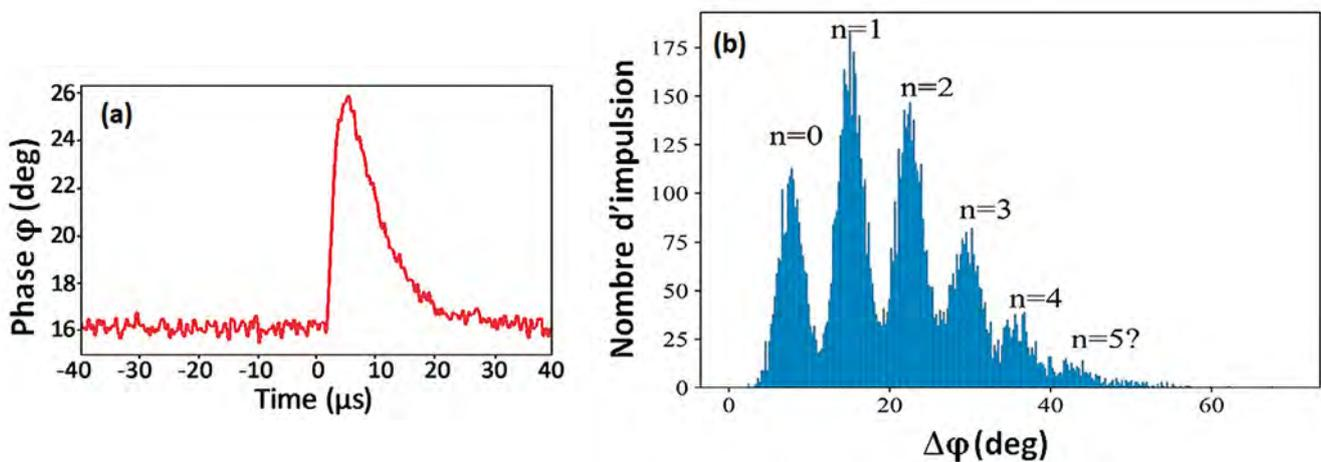
**Figure 3.** (a) Réponse temporelle de la phase du détecteur, après éclairage, permettant d'estimer le temps de vie des quasiparticules. (b) Réponses du MKID à un train d'impulsions courtes de très faibles intensités permettant de mettre en évidence le régime comptage de photons.
