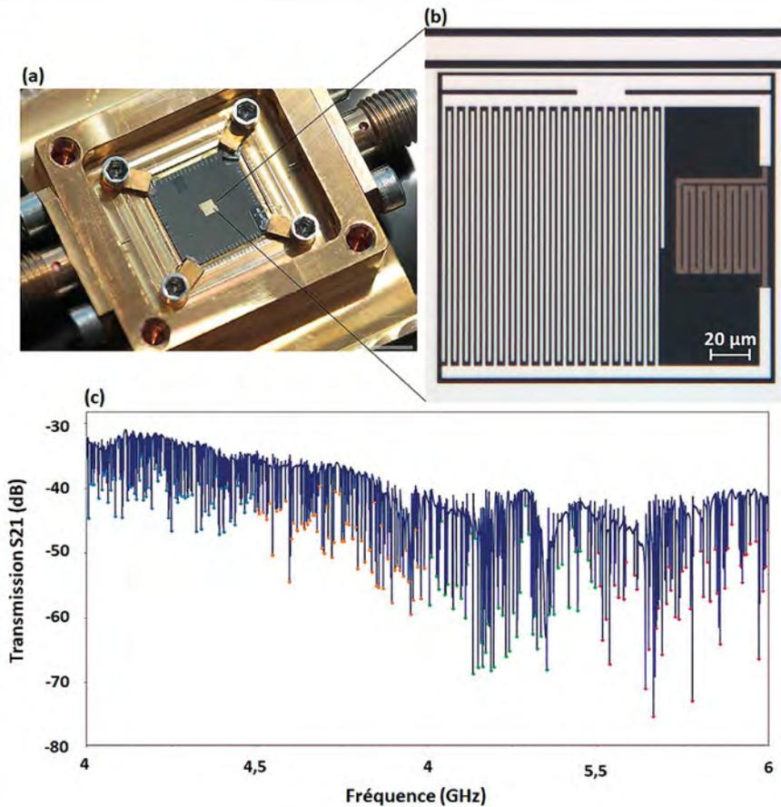
**Figure 2.** (a) Image prise au microscope optique de la matrice LEKIDS de 1000 pixels. (b) Image d'un MKID isolé, optimisé pour résonner à  $f_0 = 4$  GHz. (c) Paramètre de transmission  $S_{21}$  de la ligne de lecture CPW montrant la présence d'environ 900 résonances sur 1000 attendues, mesurées à 50 mK avec un signal hyperfréquence appliqué à la ligne avec une puissance de  $P_f = -100$  dBm (0.1 pW).
