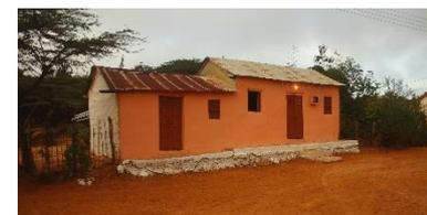
Casa de hato con techo de lámina metálica, especialmente inapropiada en la región por los fuertes vientos que generan mucho ruido en el interior. Estado Falcón - CC R Barraez D Lucca
