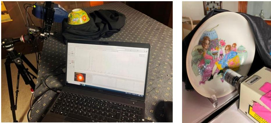
Fig. 1. À gauche, analyse sur site par fluorescence de rayons X (instrument sur son pied motorisé) ; la zone sondée est visible sur l'écran via une mini caméra. À droite, vue du spot Raman (très fortement grossi par le halo de faible intensité l'entourant) au point de focalisation de l'objectif de microscope de la tête de mesure. Dans les deux techniques la mesure est à  $\sim 10$  mm de l'instrument.
