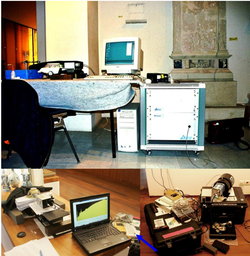
Fig. 2 : En haut, premier dispositif mobile montrant le rack sur roulette comprenant le spectromètre (flèche noire), le laser YAG refroidi par air (flèche verte), les fibres optiques (flèche rouge) et la tête de mesure déportée analysant une porcelaine de Médicis (flèche mauve) au musée national de la Céramique (Cité de la Céramique, Sèvres). En bas, les différentes composants (spectromètre, laser et dispositifs électroniques de commande) d'un système de dernière génération à haute détectivité tiennent sur les couvercles des caisses de transport ; noter le spectre (raies « fines » Raman sur le fond croissant de fluorescence) mesuré sur un bol de porcelaine émaillé produit pour un empereur Qing au musée national des arts asiatiques-Guimet, un tissu noir doit recouvrir l'objet et la tête pendant la mesure pour éviter la « pollution lumineuse » des éclairages et protéger les opérateurs (photos Ph. Colomban DR).
