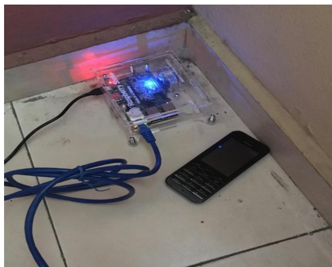
Figure 2 Photo d'un sismomètre Raspberry Shake, installé chez un hébergeur à Port-au-Prince. Le téléphone portable donne l'échelle. On aperçoit la connexion à l'électricité (câble noir) et au routeur internet (câble bleu).
